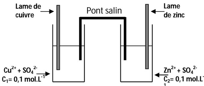
2-a- La ddp ( $V_{bZn} - V_{bCu}$ ) = - 1,10 V indiquée par le voltmètre lorsque la pile ne débite aucun courant et qui est appelée tension à vide, représente la force électromotrice de la pile.
